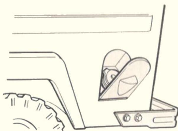
Bild 13. Einfüllstützen des Kraftstoff-
