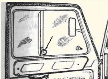
8: Bis 1982 befand sich der Wischerschalter im oberen Bereich des Frontscheibenrahmens, direkt am Scheibenwischemotor und die Scheibenwaschanlage hatte eine mechanische Pumpe mit einem separaten Betätigungsknopf am Armaturenbrett.
